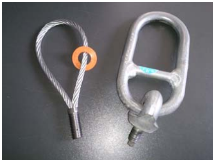
Bild: Seilschleufe bzw. HD-Abheber – Laststufe beachten
